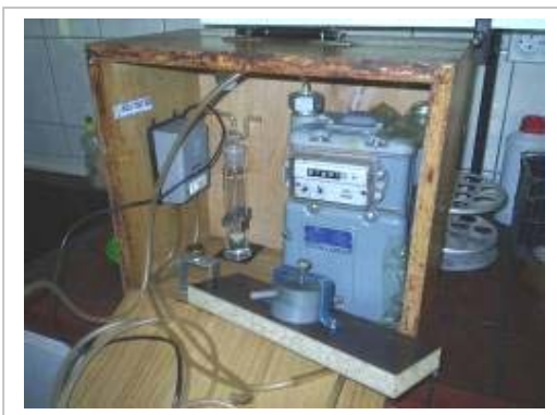
Слика бр. 1: Апаратура за мерење на концентрација на \text{SO}_2 и чад
