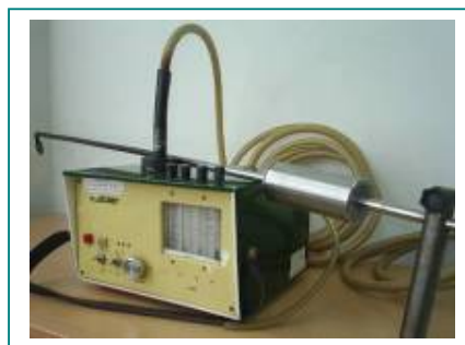
Слика бр. 4 и 5: Инструмент Gravimat SHC 500 и вакуум пумпа APA 30
