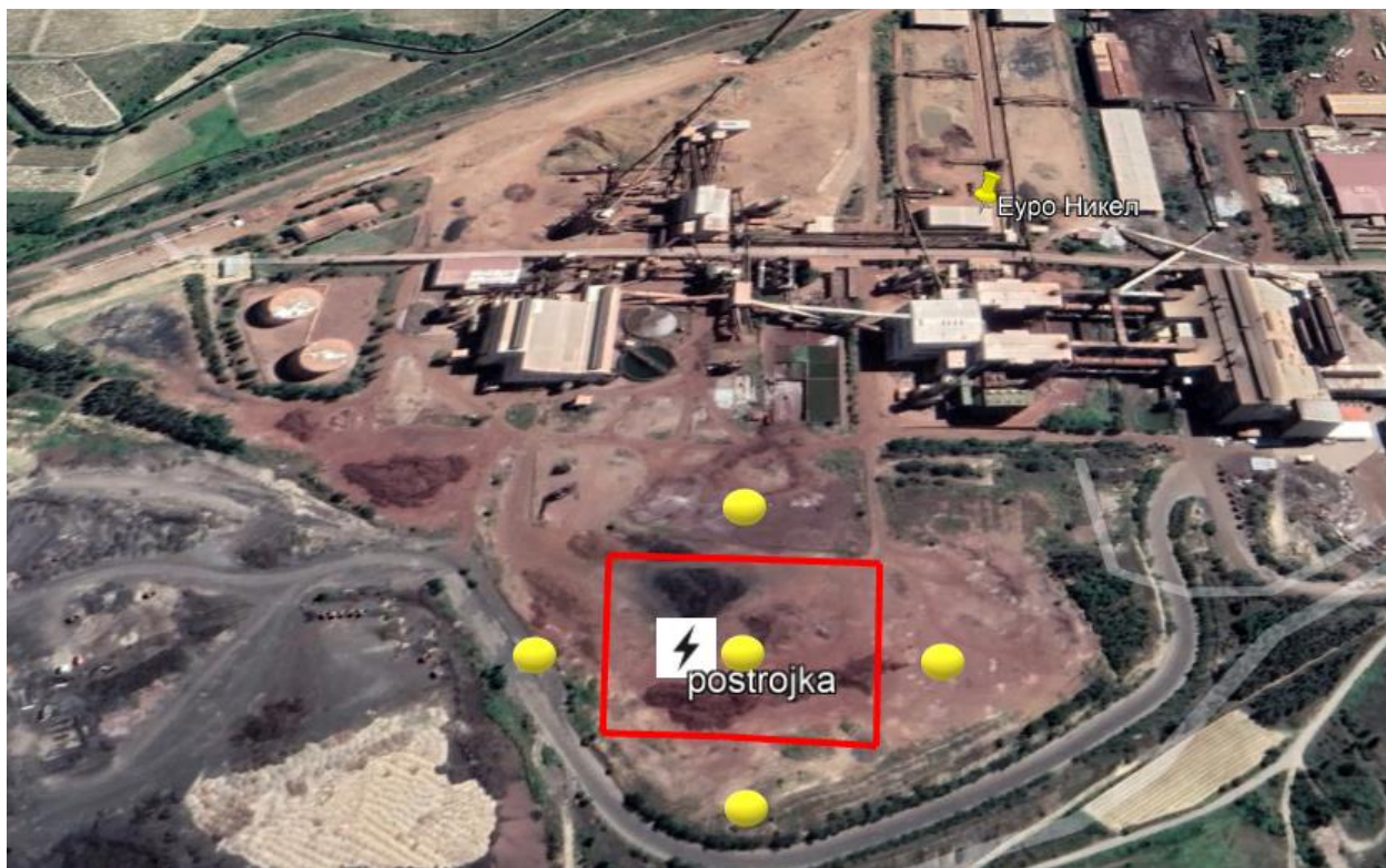
Слика 22. Позиција на мерење на бучава во средината на полигонот планиран за поставување на монтажните единици за генерирање на електрична енергија и позиции за мерење на бучава надвор од полигонот од надворешната страна на полигонот 30 метри по звучно изолационите панели во сите насоки (позициите се обележани со жолт круг)
